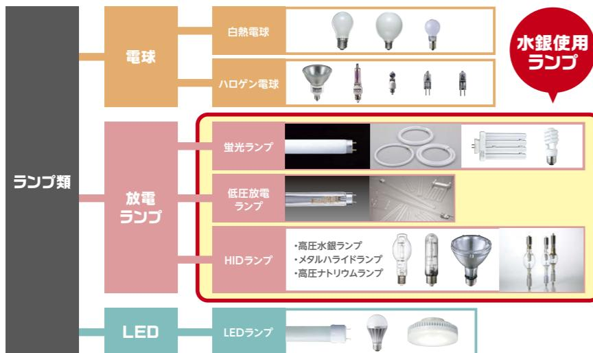
ランプは、左図のように主に白熱電球、ハロゲン電球、蛍光ランプ、低圧放電ランプ、HIDランプ及びLEDランプに分けられます。
