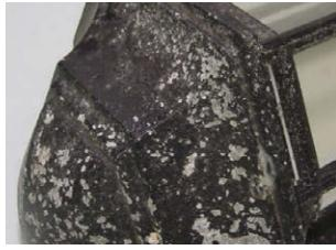
屋外器具の錆の例:屋外塩害地域への設置により、器具表面の塗膜がはがれ落ちています。
