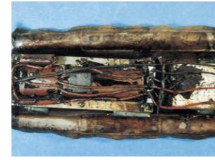
劣化の進んだ安定器の内部例:ビニル電線被覆が熱のために変形し、もろくなっています。
