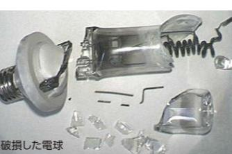
※破損した場合の怪我を防止する為に、まだ点灯していても定格寿命を経過した電球は交換をおすすめします。
