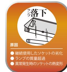
既設の蛍光灯器具をLED化する際、日本照明工業会は、器具交換を推奨しますが、G13口金直管LED光源に交換する場合は以下の注意が必要です。
